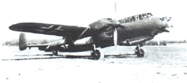
Dornier Do-217n nachtjager met radarantennes op de neus, een zusje van de Do-217e bommenwerper.
